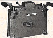
meetapparaat M 40 van 3—40 mm ø, te ijken
